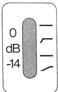
**0 dB** – Nivel de micrófono de condensador 7 mV/Pa, lineal, nivel de sobremodulación 130 dB SPL.
