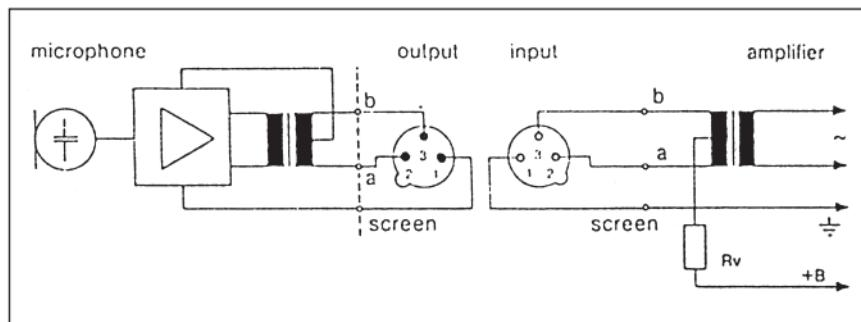
Collegamento con trasformatore d'ingresso **senza** presa mediana (senza terra).
