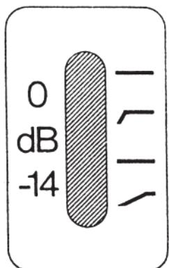
**0 dB** – Kondensatormikrofonpegel
