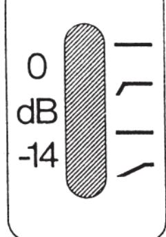
Impiego: Prevalentemente per riprese di strumenti, per ridurre vibrazioni meccaniche a bassa frequenza non desiderate.
