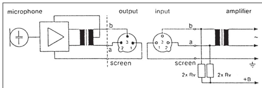
Las resistencias  $2 \times R_v$ , por motivos de simetría, deben tener como máx. una tolerancia del 0,5 %.
