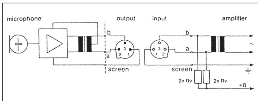
Die Widerstände  $2 \times R_v$  dürfen maximal 0,5 % Toleranz aufweisen, damit die Symmetrieanforderungen erfüllt werden.
