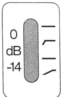
**0 dB** – niveau de microphone à condensateur (7 mV/Pa), linéaire, limite de saturation: 130 dB SPL.
