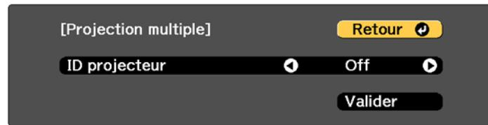
5. Appuyez sur la touche fléchée de gauche ou de droite de la télécommande pour sélectionner le numéro d'identification à utiliser pour le projecteur. Puis, sélectionnez **Valider** et appuyez sur **Enter**.
