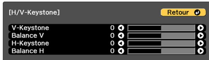
6. Utilisez les touches fléchées sur le projecteur ou sur la télécommande pour sélectionner la correction trapézoïdale verticale ou horizontale ou la correction de balance et pour ajuster la forme de l'image tel que nécessaire.
