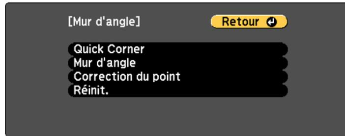
6. Sélectionnez le paramètre **Mur d'angle**, puis appuyez sur **Enter**.
