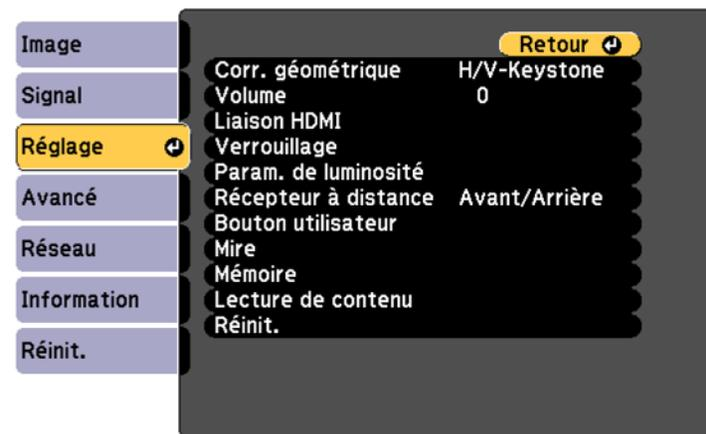
4. Sélectionnez le paramètre **Corr. géométrique** et appuyez sur **Enter**.
